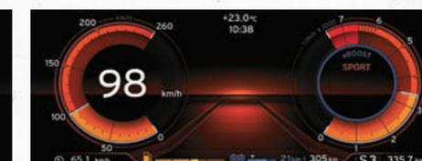
**Modus SPORT.** Dieser nur über den Gangwahlhebel aktivierbare Modus ruft die maximale Boost-Funktion des Elektromotors ab, legt das Fahrwerk für höchste Dynamik aus und verkürzt die Schaltzeiten des Steptronic Getriebes. Digitale Anzeigen für Geschwindigkeit und Drehzahl in Orange kennzeichnen diesen Modus.
