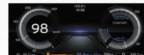
**Modus COMFORT.** In diesem Startmodus beginnt jede Fahrt rein elektrisch mit einer Geschwindigkeit von bis zu 65 km/h, bei höheren Geschwindigkeiten schaltet sich der Benzinmotor dazu. Maximaler Fahrkomfort und eine Reichweite von über 500 km<sup>4</sup> kennzeichnen diesen Modus.
