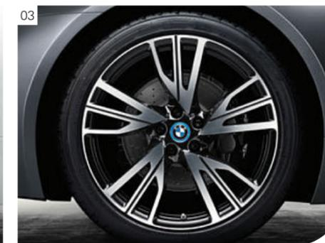
**Groß, sportlich und effizient:** Die bereits serienmäßig mit 20 Zoll Durchmesser sehr groß dimensionierten BMW i Leichtmetallräder Turbinenstyling 444 mit Mischbereifung, BMW EfficientDynamics sind in Relation zum Durchmesser besonders schmal, flächig und geschlossen ausgeführt, um den Luft- und Rollwiderstand so weit wie möglich zu reduzieren. Auf der anderen Seite sind sie so breit wie nötig, um die Leistung des
