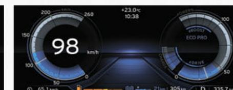
**Modus ECO PRO.** Dieser Modus rückt effizientes Fahren und Rekuperation in den Anzeigenfokus. In diesem Modus kann sowohl die maximale elektrische Reichweite<sup>4</sup> von 30 km<sup>5</sup> erreicht werden, als auch eine maximale Gesamtreichweite im kombinierten Betrieb von bis zu 600 km<sup>4</sup>.
